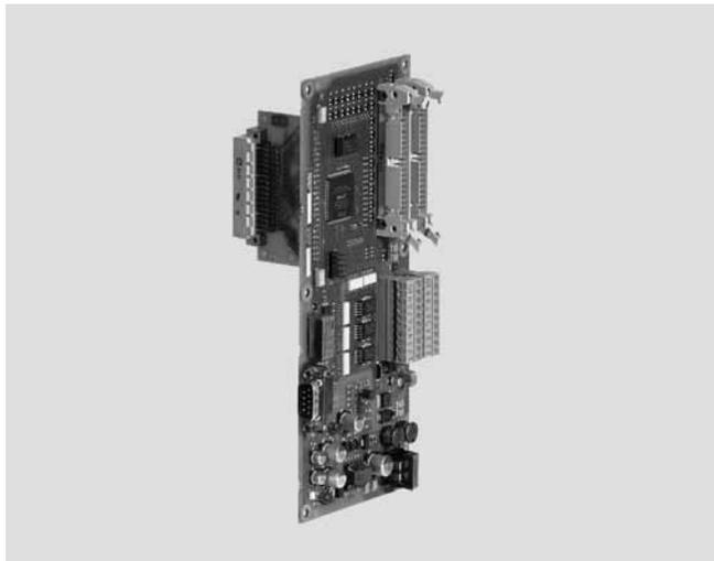
MCPA 模块配有模拟主轴的控制接口、MCP 802D sI 机床控制面板接口以及高速 NC 输入和输出的端子排。MCPA 安装在 SINUMERIK 802D sI PCU 的背面。安装套件包含在供货范围内。
